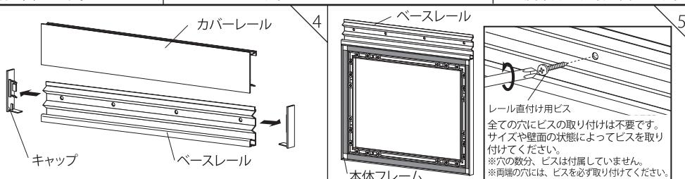
キャップをはずしてカバーレールを取りはずします。
