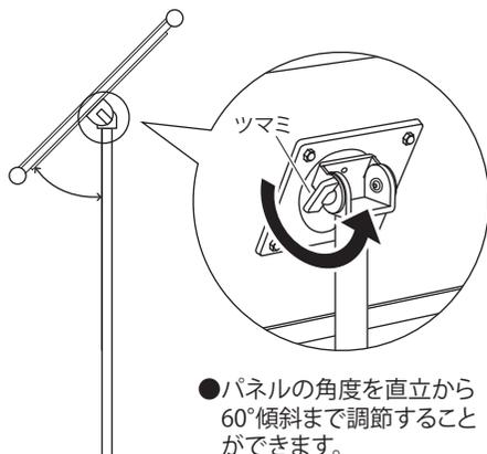
ツマミをゆるめて調節してください。(調節後はツマミをしっかり締め直してください。)
