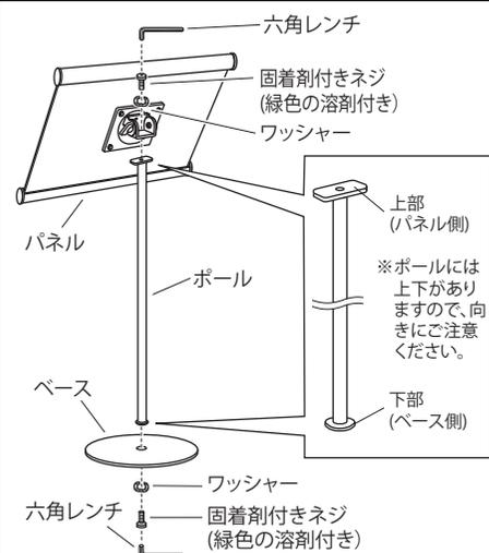
パネルとベースをそれぞれポールにワッシャー・ネジでしっかりと締めつけて固定します。(ゆるみ防止のため、ポールとベースの固定に固着剤付きネジを使用していますので、いったんネジを締めるとはずしにくくなります。)
