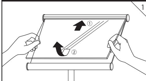
前面の透明板を上方向にスライドして取りはずします。
