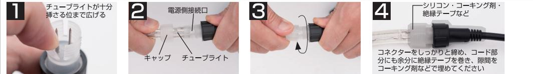
[1] カバーを広げます [2] 電源部のキャップを外し、チューブライトにくぐらせておきます。チューブライト（ロープライト）を電源コードやコントローラーなどの接続部に差し込んでください。無理に奥まで差し込みすぎるとピンが曲る場合がございますので、ご注意ください。また差し込みが浅すぎますと点灯不良の原因となりますので、ご注意ください。[3] 電源側の方をしっかりと持ち、キャップをまわしていきます。間違えて電源側の方をまわさないように、ご注意ください。[4] しっかり締めた後、防水処理を行ってください。防水処理は絶縁テープだけでは不十分ですので、必ず市販のシリコンやコーキング剤などを充填してください。
