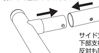
サイド支柱の出っ張り部分に下部支柱をセットをしてください
