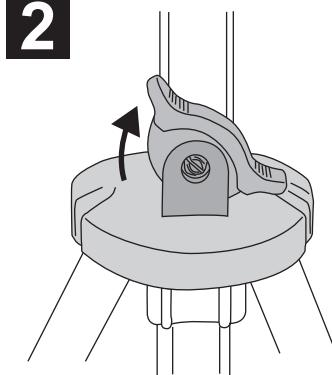
調節後、背面にあるロックバーを図のようにロックします。
