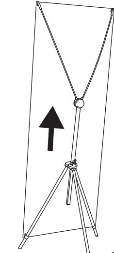
両サイドのバーを広げて、図のようにバナーを取付けます。最初に上側 2 つのハトメ穴に引っ掛けたから下側を引っ掛けます。
