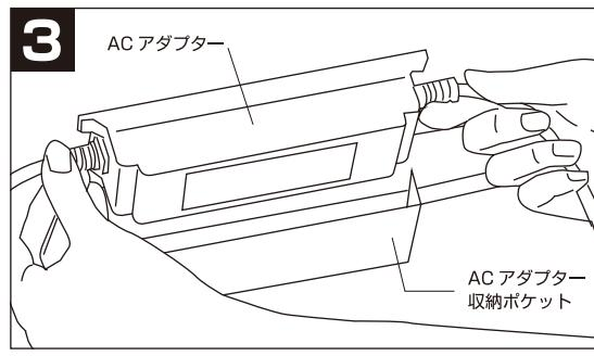
AC アダプターを収納ポケットに収納します
