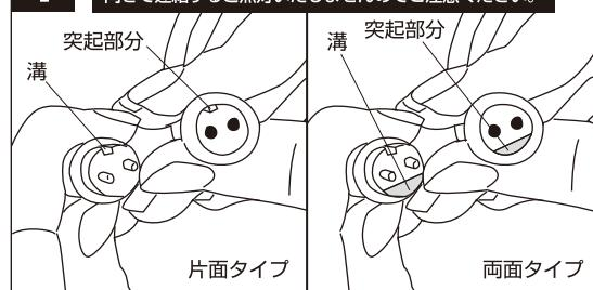
AC アダプターと本体からでている中間コードを連結させます。オス側の突起部分がメス側の溝に合うようにして連結させます。
