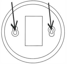
※天井のボードにネジがしっかりと固定されない場合は 付属されております、プラスチックアンカー(緑)を 先に埋め込んでいただき、そこに対してネジ固定してください
