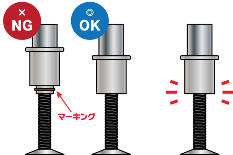
フリーアジャストナットの外装部のツバを持ち、上方向に引き上げることで、ナット機能が解除され、任意の位置に移動させることができます。
