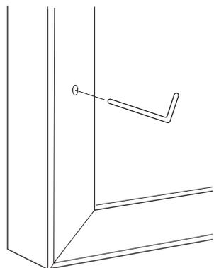
扉前面のピン穴に、ピンを差し込みます。(ピンが内部のロックを押し込み解除します。)
