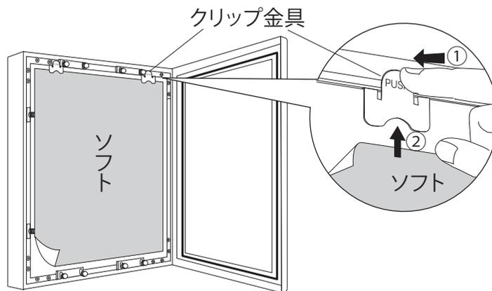
扉を開き、クリップ金具の「PUSH」部分を押し、下からソフトを差し込んでセットします。
